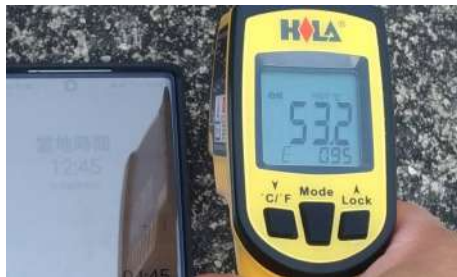
設置前頂樓層溫度 53.2 度
